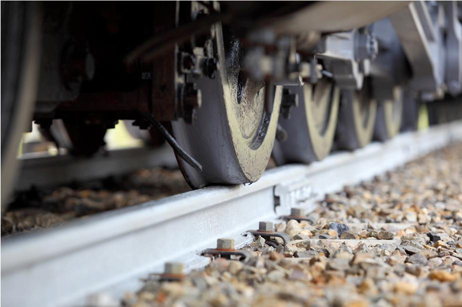
Abb. 1: Aufgrund verschiedener Faktoren, wie dem Gewicht der Waggons, der hohen Zugfrequenz, der Geschwindigkeit der Züge, der vielen Kurven und Übergänge, wie an Weichen und Schienenstößen, ist der Kontakt zwischen Rad und Schiene inzwischen extremen Belastungen ausgesetzt. Zusätzlich wirken die Bremssohlen wie bei Postkutschen auf die Laufflächen der Räder ein. Es kommt zu Überhitzungen und Rissbildungen – wie im Gotthardtunnel – so dass Räder brechen können und der Zug entgleist.
