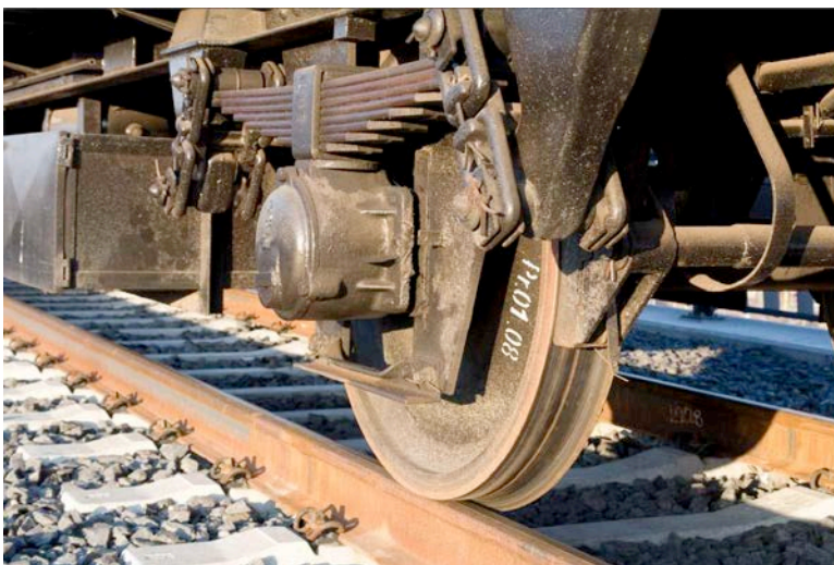
Bild 2: Bei der Graugussbremse drückt wie einst bei Postkutschen Metall auf Metall, wodurch die Lauffläche der Räder verriffelt. Mit Kunststoffbremsklötzen (z. B. LL-Sohlen) ist dieses (Lärm-) Problem gelöst. Unverständlich und für Pro Rheintal überhaupt nicht nachvollziehbar, dass Bahn und Waggonhalter sich hier nicht in der Lage sehen, umgehend Abhilfe zu schaffen.
