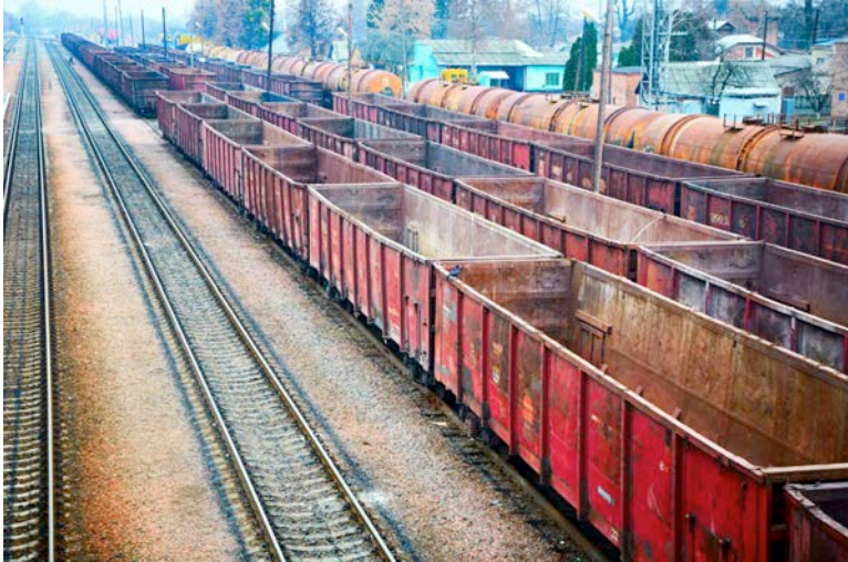
Bild 1: Alte, schlecht gewartete Güterwaggons sind die Hauptlärmquelle im Eisenbahnverkehr.
