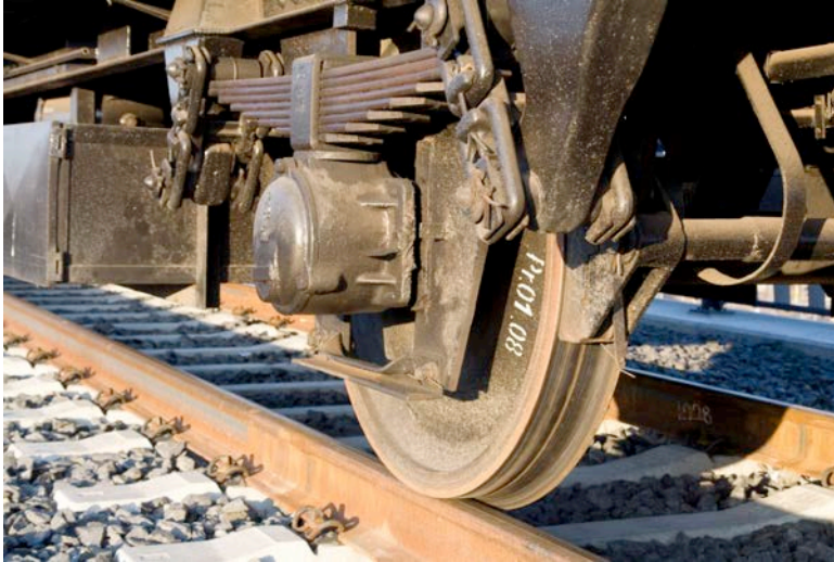
Bild 2: Der Kontakt zwischen Rad und Schiene ist für 90 Prozent des Lärms verantwortlich. Hier können glatte Räder und Schienen wahre Wunder bewirken, wie man schon heute an Bahnlinien hören kann.
