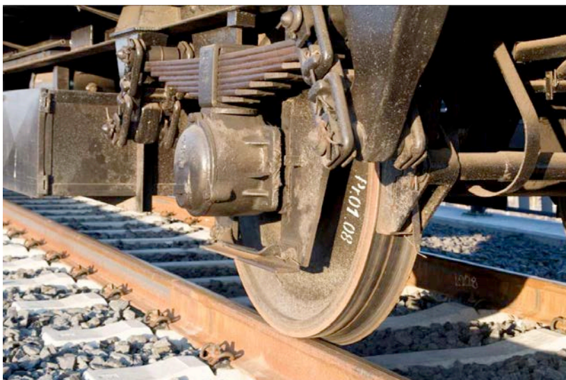
Bild 1: Noch immer werden die Laufflächen der Räder von Güterwaggonen durch Graugussbremsen verriffelt, die wie einst bei Postkutschen Metall auf Metall drücken. Mit Kunststoffbremsklötzen (z. B. LL-Sohlen) ist dieses Problem gelöst.
