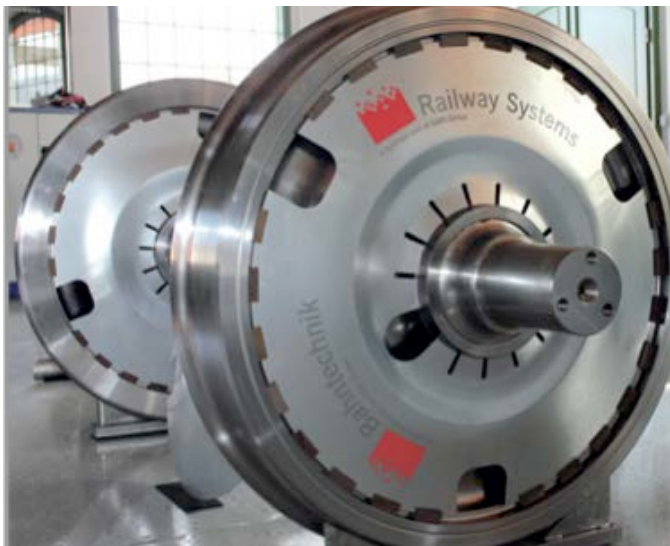
Bild 3: Ein moderner Güterwagenradsatz mit Radschallabschirmungen, um die Radgeräusche zu mindern. (Foto Hersteller: Bochumer Verein Verkehrstechnik GmbH)
