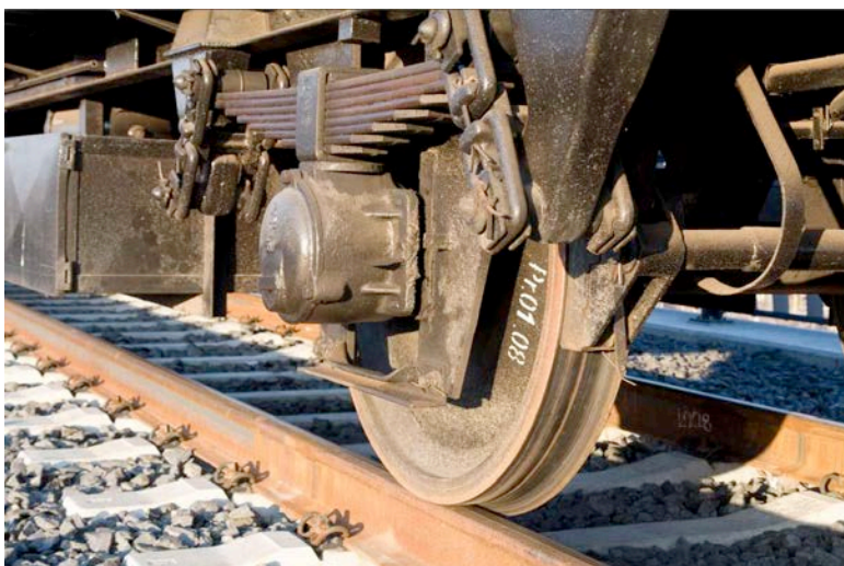
Bild 1: Noch immer werden die Laufflächen der Räder von Güterwaggons durch Bremsen verriffelt, die wie einst bei Postkutschen Metall auf Metall drücken. Mit Kunststoffbremsklötzen ist dieser Fehler schnell und einfach zu beheben.
