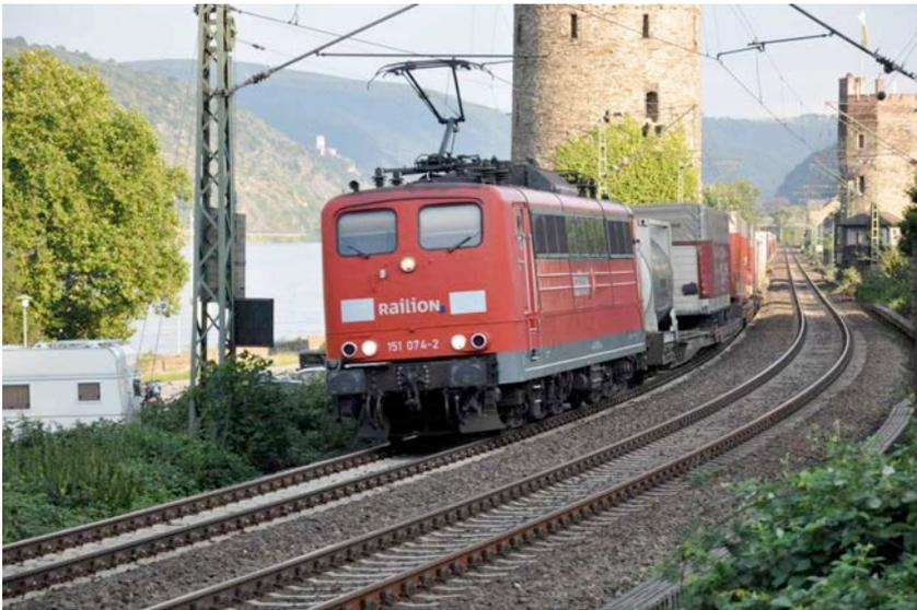
Bild 1: Alte Güterwaggons mit Graugussbremsen verursachen den größten Teil des Bahnlärms im Rheintal. Sie gehören entweder aufs Abstellgleis oder in die Werkstatt, um auf die neuen Flüsterbremsen umgerüstet zu werden.
