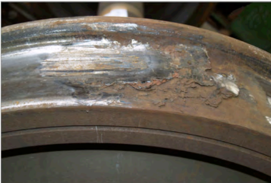
Bild 1: Flachstellen, umgangssprachlich auch als „Bremsplatten“ bezeichnet, sind Beschädigungen der Laufräder von Güterwaggons, die zum Verriffeln durch gusseiserne Bremsen hinzukommen und den ungeheueren Lärm ausmachen, der von alten Güterwaggons ausgeht.
