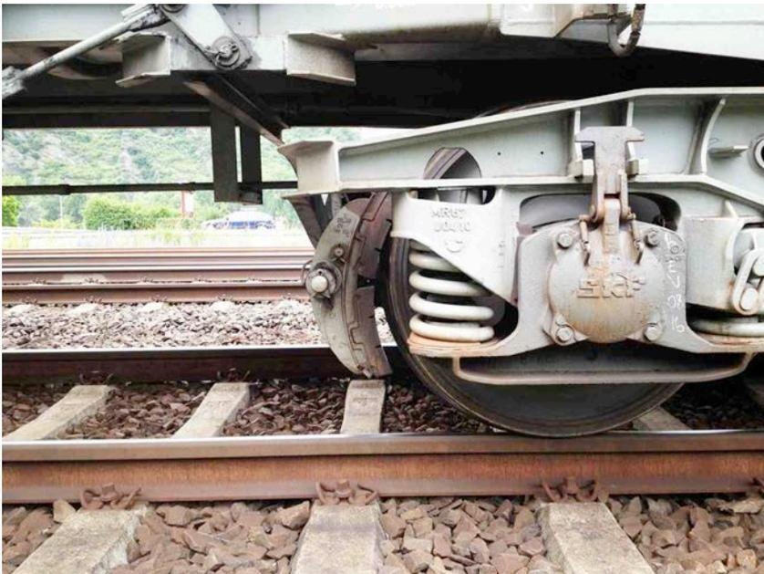
Bild 2: Der Kontakt zwischen Rad und Schiene macht 90 Prozent der Lärmemissionen aus. Kunststoffbremsen sorgen für glatte Räder, damit auch die Schienen glatt bleiben und die Züge flüsterleise vorbeifahren.
