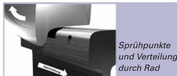
Das Schienenkonditioniersystem von Rail Partner Deutschland löst diese Probleme, indem es den Lärm unmittelbar an der Quelle ausschaltet. Die bewährte Technik erreicht eine Lärmreduktion von bis zu 20 dB (A). Außerdem verbessert sich die Verschleißsituation an den Schienen. Für Bahnanwohner bedeutet das eine Verbesserung ihrer Lebensqualität.
