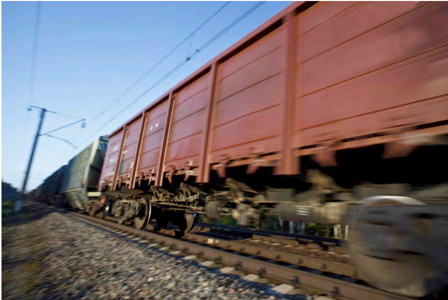
Bild 1: Unten herum ungeschützt und offen pusten Güterwaggons bis zu 110 dB(A) Lärm in die Luft. Dieser Lärm lässt sich nicht mehr einfangen. Aber man könnte an Rad und Schiene sowie durch Abschirmungen dafür sorgen, dass kaum noch etwas zu hören ist – sagt Pro Rheintal.
