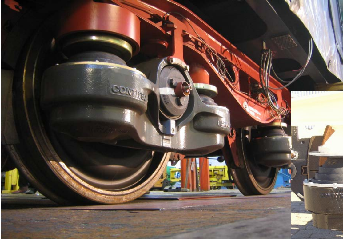
Prototyp der Gigabox mit Messverkabelung an einem Rilnss Güterwagen
