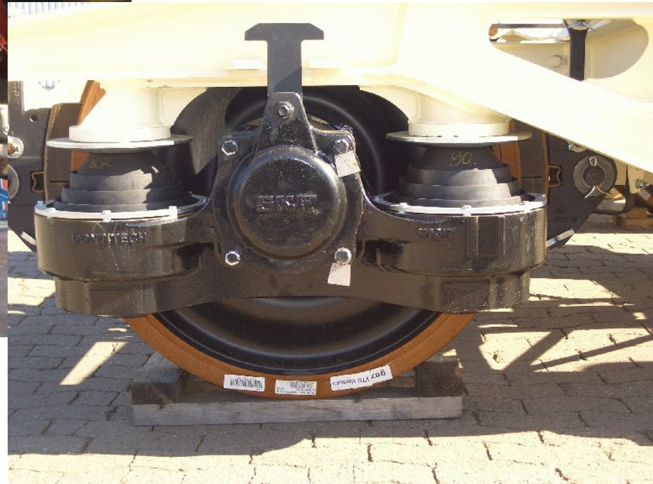
Aktuelle Ausführung der Gigabox mit Anpassung an einen vorhandenen Y25 Drehgestellrahmen
